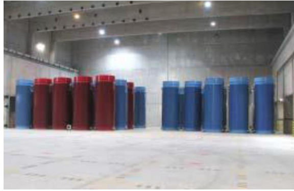
M1. ábra: példák a kiégett fűtőelem-kazetták konténeres átmeneti tárolására (forrás: Paks2 környezeti hatástanulmány)
